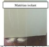
Partie non traitée : Partie traitée : Friable en surface, émission de particules Pas d'émission de particules
